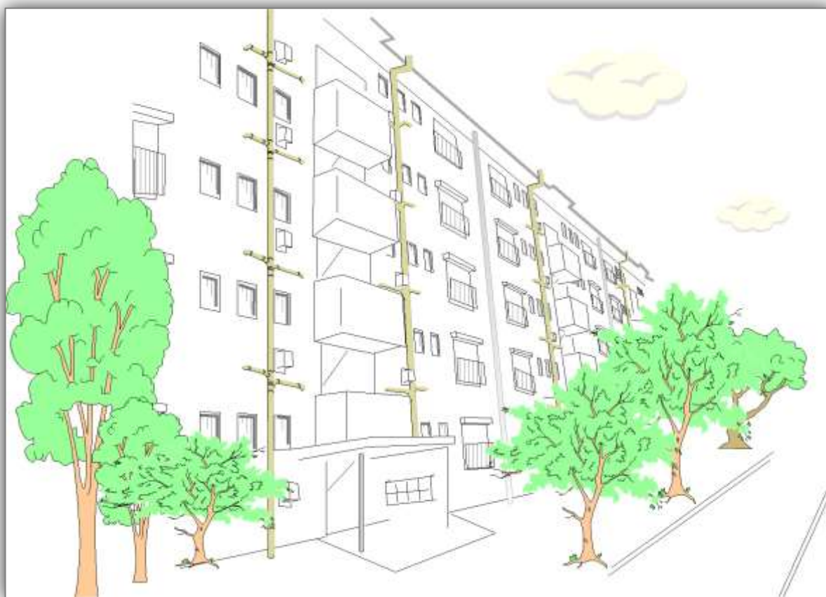
立管施工後の外観イメージ図
